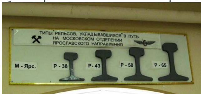
Типы рельсов. Циферки 38, 43 и т.д. соответствуют массе 1 м рельса
